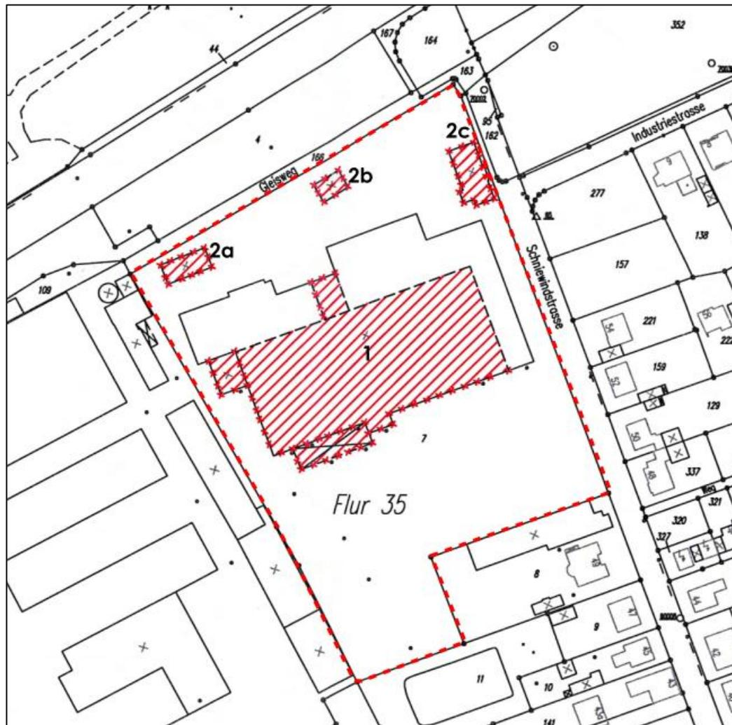
Abb. 2 Fabrikgelände und zum Abbruch vorgesehene Gebäude (M 1 : 2.000)
