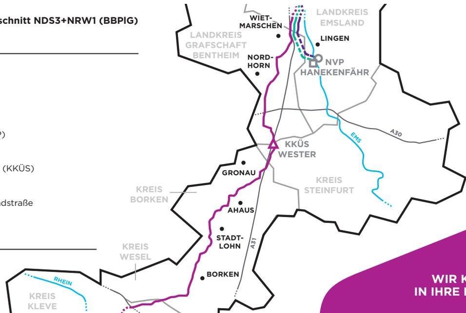
Die Gleichstromverbindung A-Nord soll Windstrom aus dem Nordseeraum in Emden aufnehmen und in Richtung Rheinland transportieren. Die Erdkabeltrasse ist als Vorhaben Nummer 1 im Bundesbedarfsplangesetz verankert. Die etwa 300 Kilometer lange Stromleitung verläuft dabei auch durch den Landkreis Grafschaft Bentheim sowie die Kreise Steinfurt und Borken. Wir von der Amprion haben den gesetzlichen Auftrag, die Leitung zu bauen und zu betreiben.
